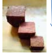
MEIDIDAS: 4 A 6, 6 A 8 Y 8 A 11 cm LA MISMA MEDIDA DE LARGO ANCHO Y ESPESOR
